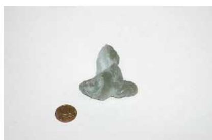
Рис 9. Клинкер высокоглиноземистый состав ВГЦ-1
