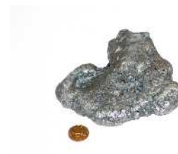
Рис 13. Сплав ферровольфрамникель Fe – 36,4%, W-34,4%, Ni – 29,2%
