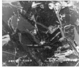
Рис 2 Микроструктура плавленных клинкеров. C_4AF (ПК-4)
